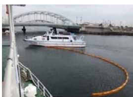
オイルフェンスによる 漂流物の囲い込み
