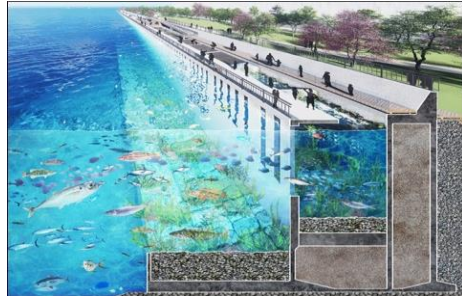
【生物共生型港湾構造物の整備】
