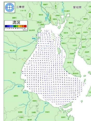
海洋短波レーダーによる 表層流の観測
