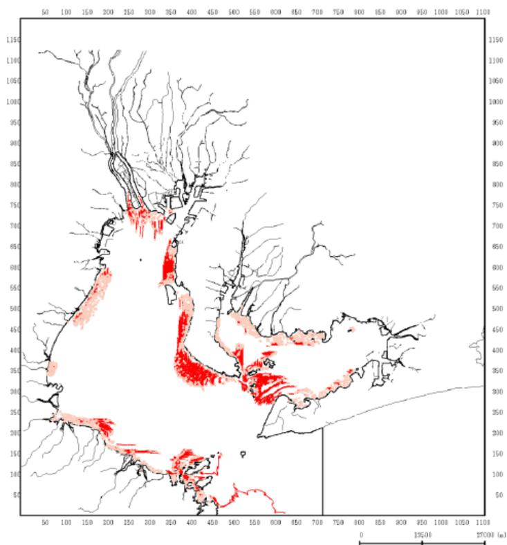
図 28 津波による漂流軌跡図【養殖施設、小型船舶】(10日間冬期風)
