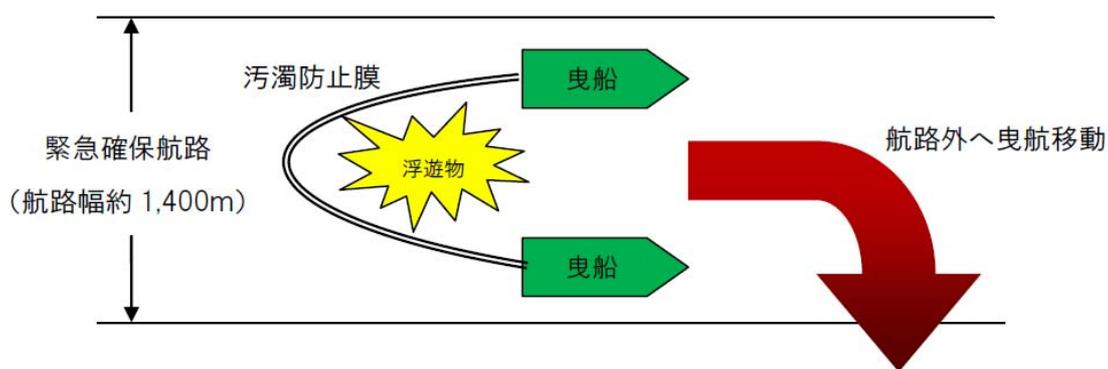
必要な資機材は、2 隻の曳船と汚濁防止膜（シルトプロテクターやオイルフェンス）1 張が 1 セットとなる。この際の汚濁防止膜の長さは、主要航路幅の 1 ～1.5 倍程度以上が必要である。緊急確保航路等の幅は約 1,400m であり、航路内に広げた汚濁防止膜（約 1,000～1,500m を想定）によって浮遊物を囲い込み、航路外へ曳航移動させる。汚濁防止膜で集めた浮遊障害物は、陸揚げされるまでのしばらくの間、そのまま海上で放置する場合もある。
