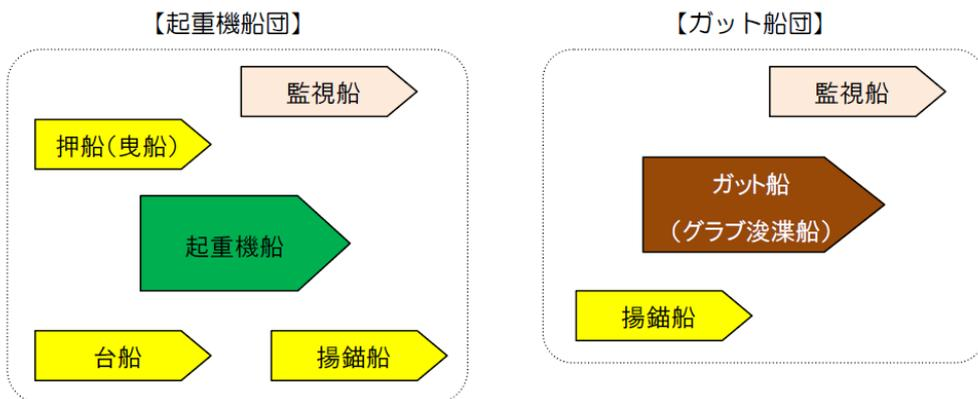
注) 起重機船の代用としてクレーン付き台船なども投入可能。
