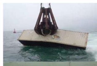
グラブバケットによる揚収作業（揚収物が破損する可能性がある）
