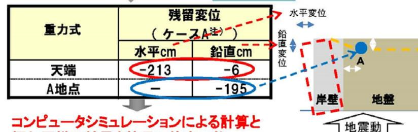
コンピュータシミュレーションによる計算と概ね同様の結果を簡易に算定可能
