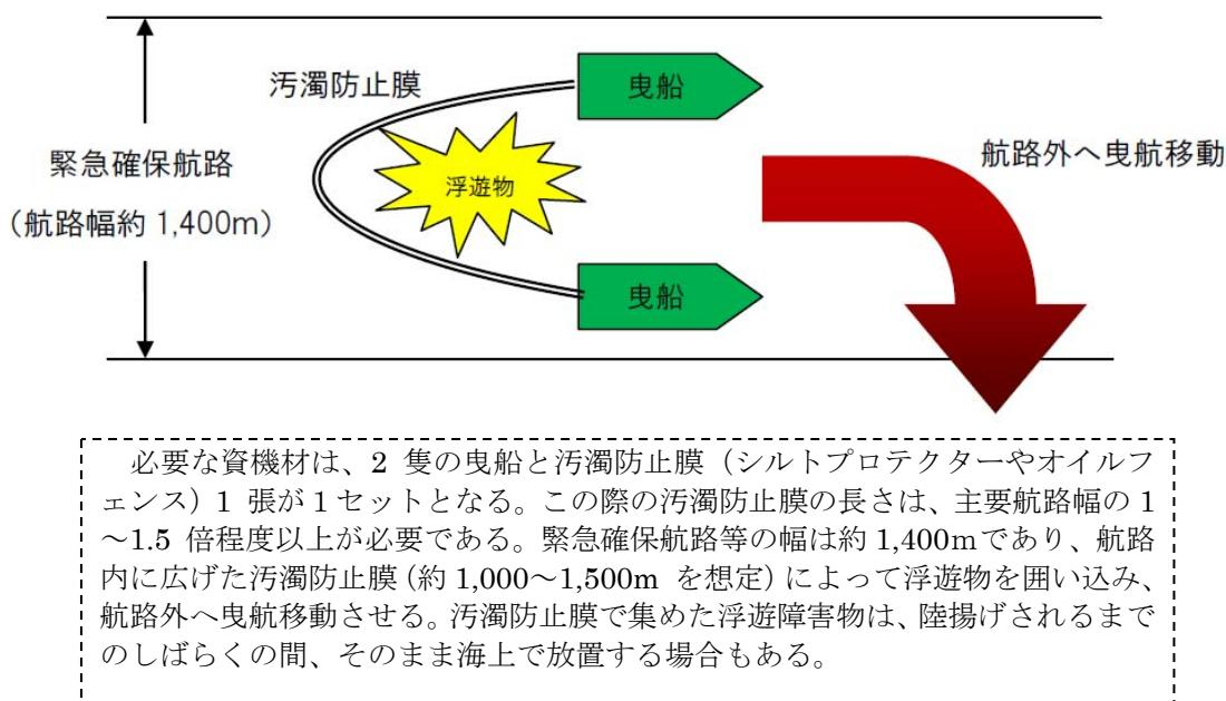
図 13 浮遊物の囲い込み（封じ込め工）の作業態勢（港湾区域内）
