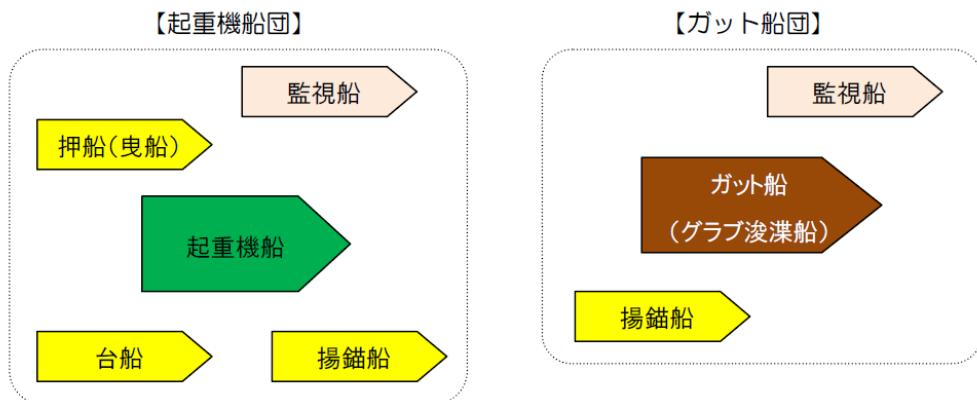
注)超重機船の代用としてクレーン付き台船など
