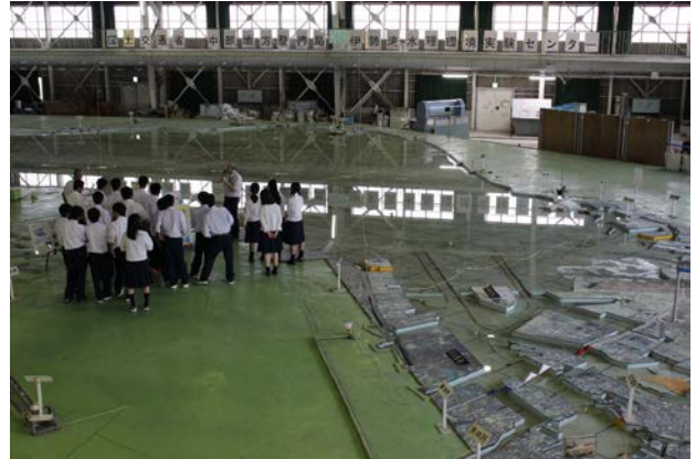
伊勢湾環境水槽における疑似津波実験
