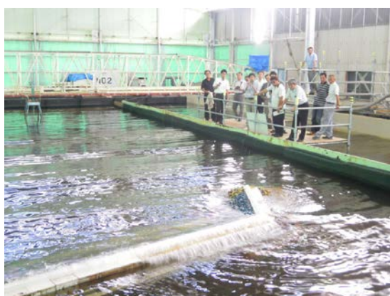
波浪平面水槽における防波堤実験
