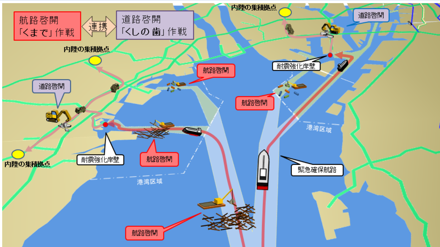
航路啓開と道路啓開が連携した緊急物資輸送イメージ(伊勢湾)
