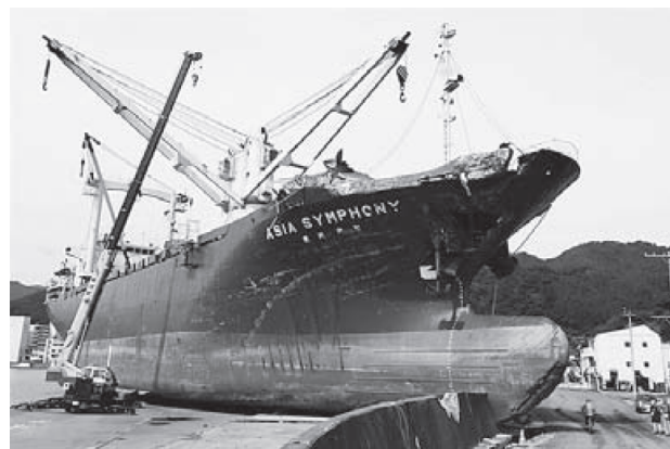
釜石港で岸壁に乗揚げた貨物船 (4,724GT、全長100m、津波浸水高 約11m)
