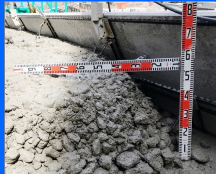
最大粒径80mmの骨材を 使用したコンクリート
